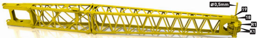
Teile R1 und K1 in den Arm auf eine Rundstange mit dem Durchmesser von 0,5 mm annadeln. **Alles mit Untersätzen 18 abgrenzen!** Auf die Aussenseite von dem Arm Untersätze 18 und Teilchen 19 löten. vorsichtig löten, damit die Teile R1 und K1 beweglich bleiben.
