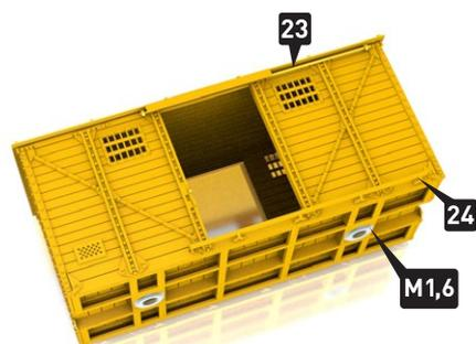
Před vletováním dílku 23 a naohýbaného dílku 24 pročistěte otvory vrtáčkem 0,3 mm. Vletujte matice M1,6.
