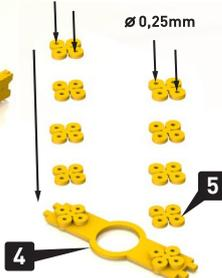
Dílek 6 v případě stavby nebrzděného podvozku nepoužijete. Na pomocné struny průměru 0,25mm vletované do dílku 4 navlékněte dílky 5. Navrch navlékněte dílek 7.
