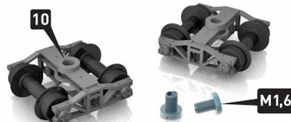
Výšku skříně nad podvozky vymezte pomocí podložek 10. (Typicky stačí po jednom kusu).
