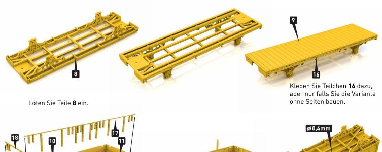
**Zuerst** löten Sie Beschlagteile **17** und **18** von oben auf die Seiten, dann kommt das Biegen und Durchlöten.
