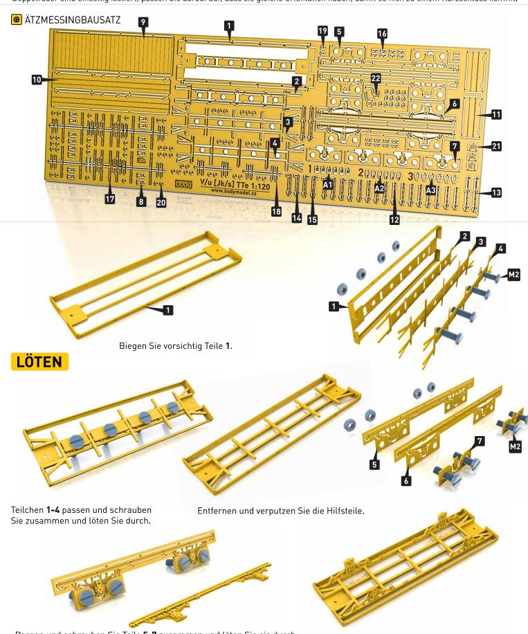
Passen und schrauben Sie Teile **5-7** zusammen und löten Sie sie durch, entfernen und verputzen Sie die Rahmen.
