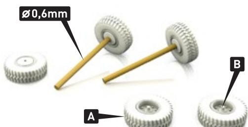
Je-li to nutné, opatrně zvětšte vnitřní průměr pneumatiky (např. svitkem smirkového papíru). Jako osičku použijte kulatinu průměru **0,6mm**.
