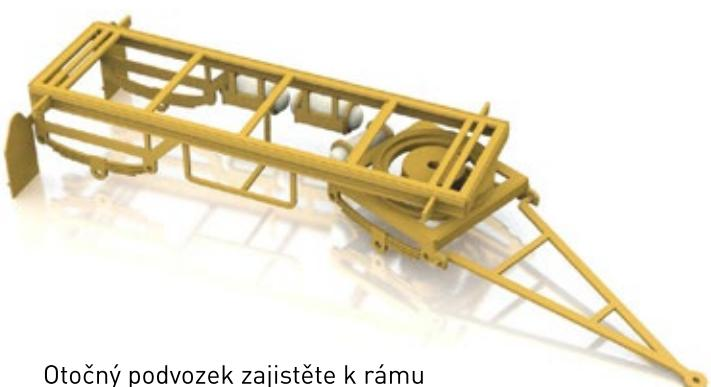
Otočný podvozek zajistěte k rámu vhodným čepem, např. špendlíkem.
